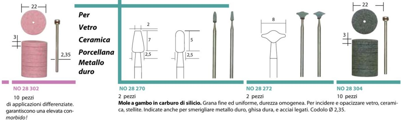
**Mole a gambo in carburo di silicio.** Grana fine ed uniforme, durezza omogenea. Per incidere e opacizzare vetro, ceramica, stellite. Indicate anche per smerigliare metallo duro, ghisa dura, e acciai legati. Codolo Ø 2,35.
