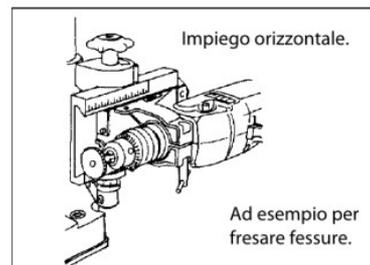
**Testata portatrapano inclinabile fino a 90°. Pertanto molteplici possibilità d'impiego:** foratura obliqua, molte varianti di fresatura senza dover ricorrere a frese speciali, fresatura di asole oblique.
