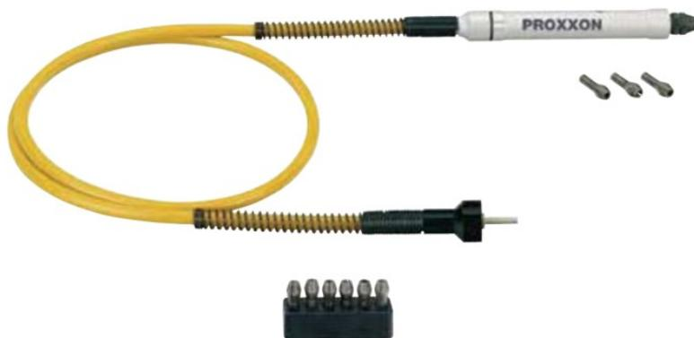
Asse in acciaio rettificato con doppia cuscinettatura a sfere alesato per pinze di serraggio in acciaio MICROMOT. Terminale lato macchina con un terzo cuscinetto. Anima interna ad elevata flessibilità (non si surriscalda con raggi di curvatura stretti). Lunghezza 100 cm. Massimo numero di giri consentito 25.000/min. In dotazione 6 pinze di serraggio in acciaio (1 – 1,5 – 2 – 2,4 – 3 e 3,2 mm).
