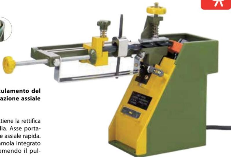
**La riaffilatura avviene nel prisma mediante basculamento del braccio che contemporaneamente compie una rotazione assiale obbligatoria.**
