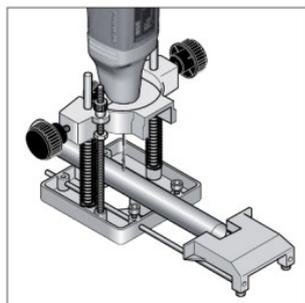
Sia con la guida parallela (massima estrazione 150 mm), sia per fresature circolari con perno di centraggio (100 - 400 mm) altrimenti a mano libera. In pressofusione di alluminio con superficie d'appoggio rettificata. Battuta di profondità regolabile con corsa preselezionabile. Ideale anche come ausilio per forare pezzi tondi sfruttando il prisma nella piastra di guida.
