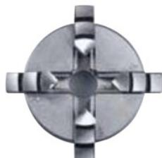
Per serrare pezzi quadrati o ottagonali. Elevata precisione, Capacità di serraggio con griffe invertibili interna 1 – 20 mm, esterna 20 – 50 mm. Ø 50 mm.
