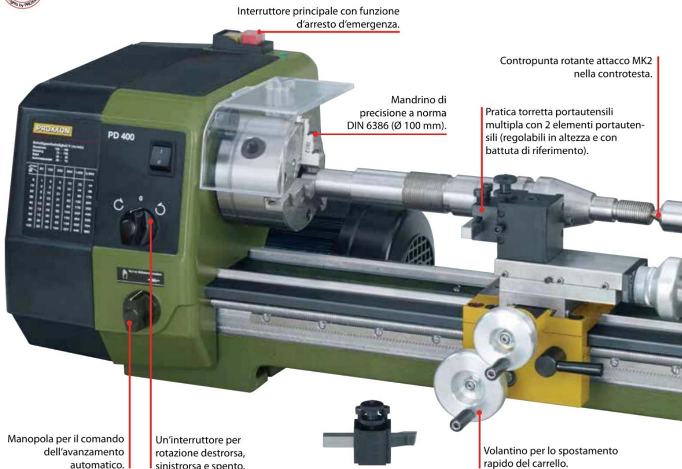
**Larghezza tra le punte 400 mm. Altezza delle punte 85 mm. Altezza delle punte sulle guide 58 mm.**
