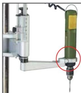
Grazie al pratico interruttore a bilanciere per la marcia avanti e indietro e un numero di giri di 250/min il MIS 1 è ideale per filettare. Il maschio per filettare viene guidato con precisione e garantisce filettature interne estremamente precise, esattamente verticali.
