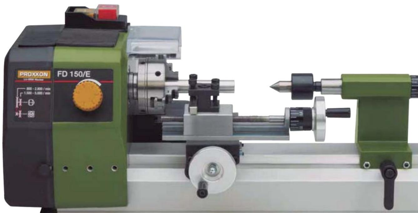
**Distanza tra le punte 150 mm. Altezza delle punte 55 mm. Altezza delle punte sulla slitta trasversale 33 mm.**
