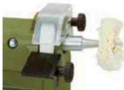
**Dati tecnici:** 230 V. 3.000 – 9.000 giri/min. Mola 50 x 13 x 12,7 mm. Velocità di smerigliatura da 8 a 24 m/sec. Peso circa 1200 g. Dimensioni circa 250 x 130 x 100 mm.
