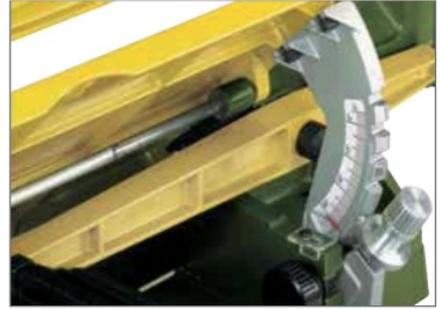
**Innovativa soluzione brevettata di un problema:** per facilitare il cambio lama, il tavolo orizzontale può essere sbloccato e spostato indietro di 80 mm. Libera visuale soprattutto sul braccio sega inferiore quando si va ad agganciare il blocchetto portalama o il pernetto trasversale della lama.
