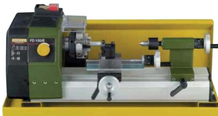
**Per tornire in piano, tornire longitudinalmente eseguire torniture coniche ed eseguire filettature. Per la lavorazione plastica. Flangia rettificata per il fissaggio della fresatrice-foratrice PF 230.**
