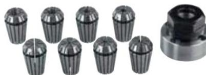
Per la lavorazione molto precisa di pezzi tondi. La attrezzatura con pinze va montata al posto del mandrino. Con 8 pinze di serraggio (2 - 2,5 - 3 - 4 - 5 - 6 - 8 e 10 mm). Custodita in cassetta di legno.
