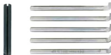
Utensile per filettatura metrica 60° e whitworth 55°. Un incisore da 1,3 mm uno da 2,65 e uno da 4 mm. Codoli 6 mm. Lunghezza totale 95 mm. Gli utensili vanno inseriti nel portautensili accluso (8x8 mm) e fissati nella torretta portautensili del PD 230/E, PD 250/E o PD 400. In cassetta di legno con coperchio scorrevole.
