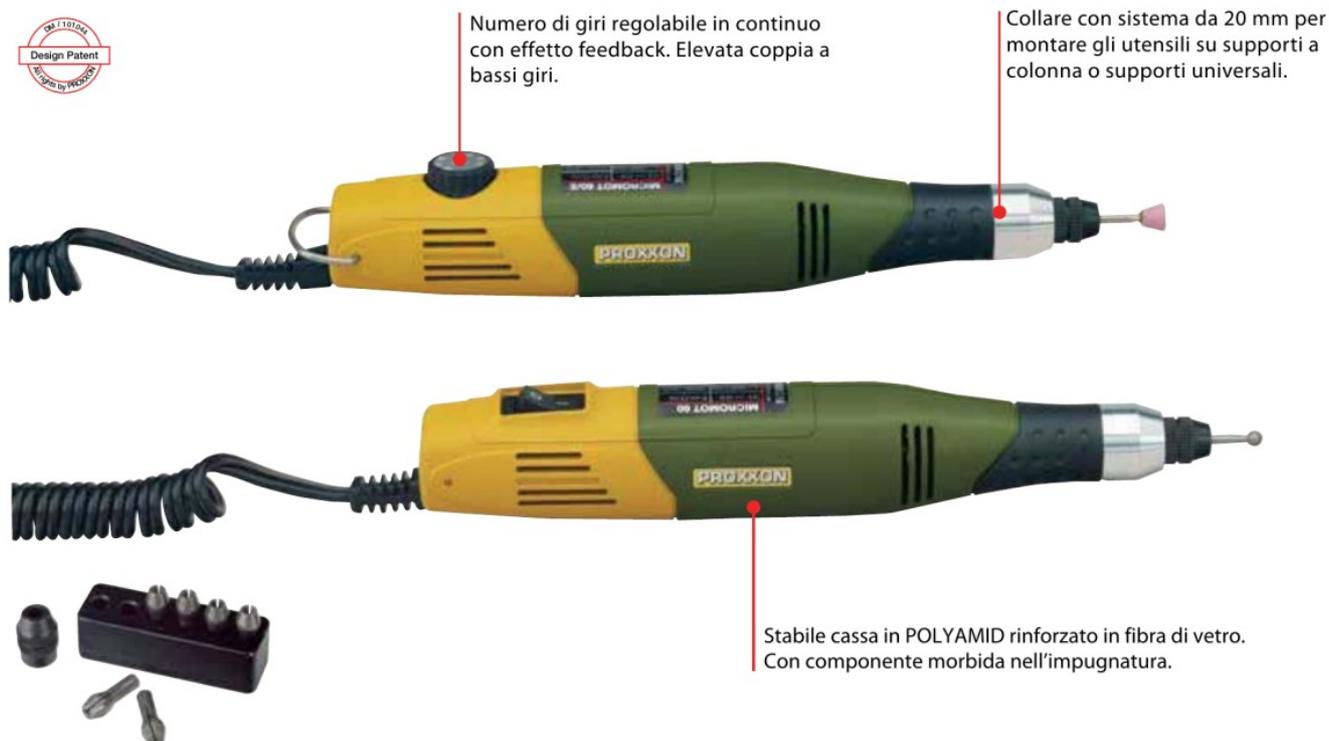
Con un diametro di soli 35 mm è il massimo della maneggevolezza. In più il peso contenuto (ca. 230 g), una tonalità piacevole e scorrevole motore bilanciato con asse portautensili rettificato montato su cuscinetti a sfere. Anche i più piccoli gambi vengono serrati concentricamente grazie alle precise pinze di serraggio MICROMOT in acciaio (descrizione qui sotto). Gli utensili inseriti non vibrano e non sobbalzano.
